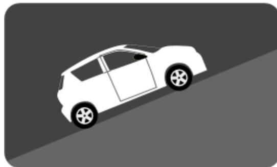
En este tipo de vía, cuando se realiza un proceso de aceleración, el intervalo de revoluciones asignado para el cambio de marchas se atrasa en cierta medida. Se cambia entonces de marcha a un número más alto de revoluciones, al venir frenado el proceso de aceleración por la pendiente que opone la vía. El retraso en el cambio depende nuevamente de la pendiente que presente el camino.
