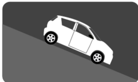
Cuando en una vía con pendiente descendente se realiza un proceso de aceleración, el intervalo de revoluciones asignado para el cambio de marchas se adelanta en cierta medida, es decir, se cambia de velocidad a un número más bajo de revoluciones dada la ayuda del proceso de aceleración producida por la pendiente que presenta la vía.
