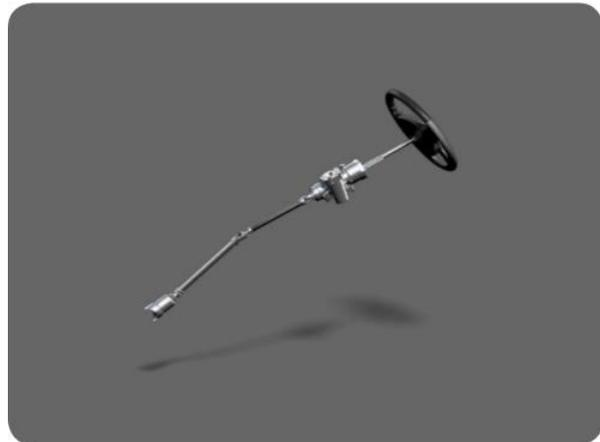
La finalidad de este sistema es evitar que, en caso de choque frontal, la columna de dirección retroceda y el volante cause lesiones.
